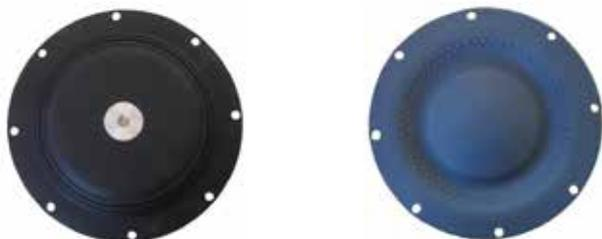
La membrane TU ne possède un raccord d'arbre que du côté air, et une surface côté liquide facile à nettoyer. Cela signifie qu'il n'y aura pas d'accumulation de résidus d'encre ou de peinture derrière les boulons et disques de centrage entre autres, et évite donc une contamination des couleurs. Plage de température : de -10 °C à 90 °C.
