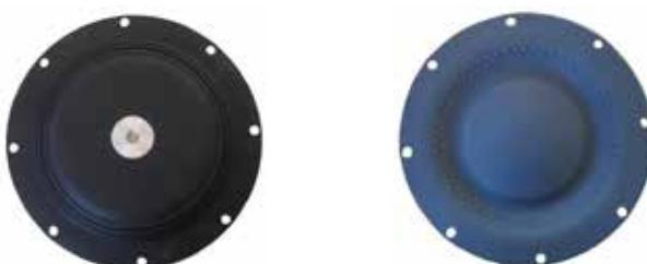
Мембрана из TU имеет соединение для штока только со стороны воздуха и тефлоновую поверхность со стороны жидкости, которая легко очищается. Это означает, что за болтами, центральными дисками и другими элементами оборудования не будут накапливаться остатки чернил или красок, благодаря чему устраняется загрязнение цвета. Диапазон температур: от 0° С до 85° С с кратковременной пиковой нагрузкой до макс. 100° С
