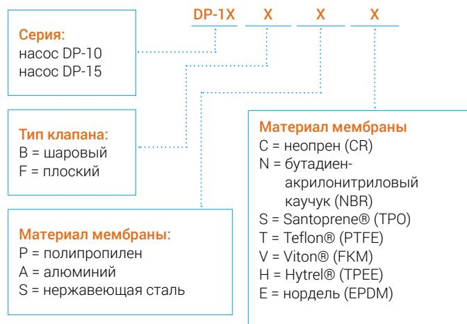
Насосы серии DP-15 в стандартном исполнении комплектуются плоскими клапанами. Шаровый клапан устанавливается по заказу. Дополнительные варианты оснащения по заказу приведены на стр. 35.
