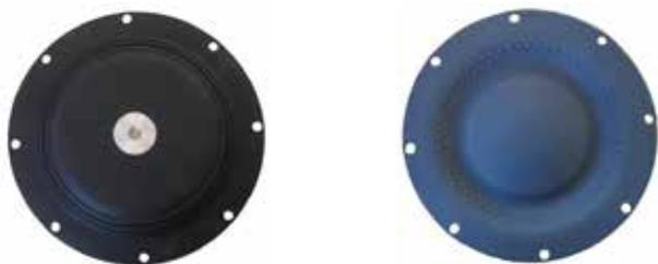
La membrana TU solo tiene una conexión de varilla en el lado neumático y cuenta con una superficie del lado del líquido, fácil de limpiar. Esto quiere decir que no se acumulan residuos de tinta o pintura detrás de los pernos, discos centrales, etc., lo que evita la contaminación del color. Rango de temperatura: de -10 °C a 90 °C.
