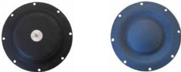
La membrana TU solo tiene una conexión de varilla en el lado neumático y cuenta con una superficie del lado del líquido, fácil de limpiar. Esto quiere decir que no se acumulan residuos de tinta o pintura detrás de los pernos, discos centrales, etc., lo que evita la contaminación del color. Rango de temperatura: de 0 °C a 85 °C, con una breve carga pico, hasta un máximo de 100 °C
