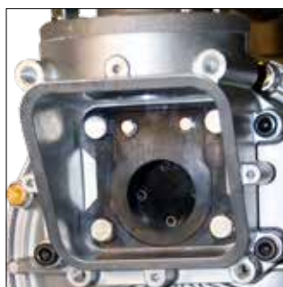
4 boulons pour accéder aux clapets plats
